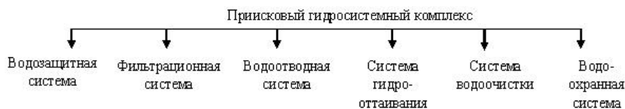
Рис. 6. Общий состав приискового гидросистемного комплекса при бульдозерном и скреперно-бульдозерном способах открытой разработки россыпей/ Fig. 6. The total composition of geodesic hydraulic system complex at the bulldozer and scraping-and-bulldozer methods of open-cast mining
