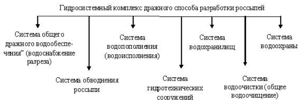
Рис. 8. Общий состав гидросистемного комплекса дражных разработок россыпей/ Fig. 8. The overall composition of the hydrosystem complex of dredging mining of placers
